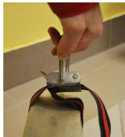
NEPRAVILNO ZAPET CEVNI NOSILEC
